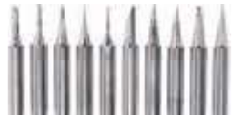
Tip types: T-1, T-B, T-K, T-1.2D, T2.4D, T-3.2D, T-1C, T-2C, T-3C Rodzaje grtów: T-1, T-B, T-K, T-1.2D, T2.4D, T-3.2D, T-1C, T-2C, T-3C
